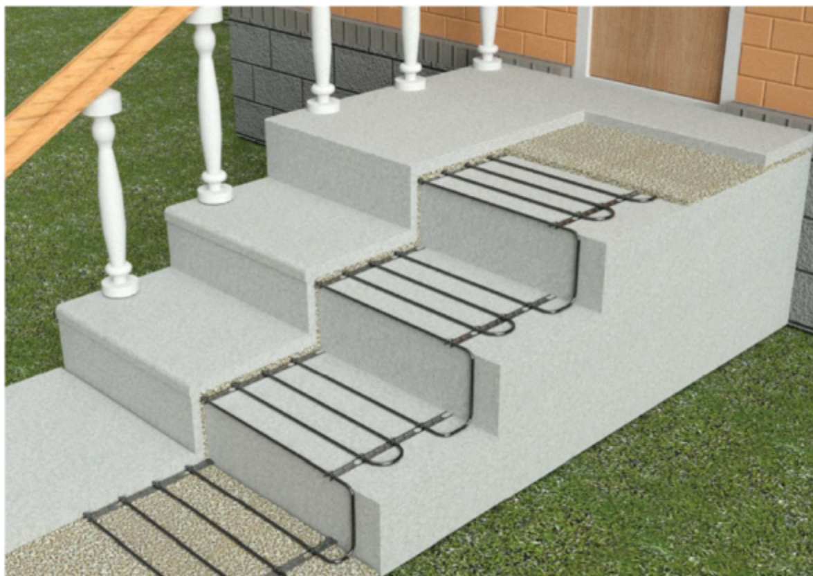
Монтаж нагревательного кабеля на ступенях крыльца.
